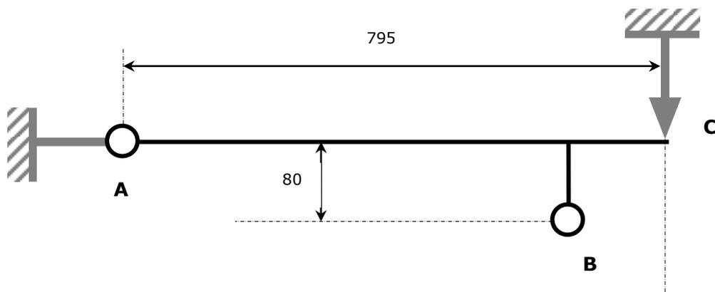
Q2 - Par une application du **Principe Fondamental de la Statique** au vantail et par l'exploitation de l'équation d'équilibre de moment autour d'un axe approprié, calculez ci-dessous  $F_c$  dans la situation ci-dessus.
